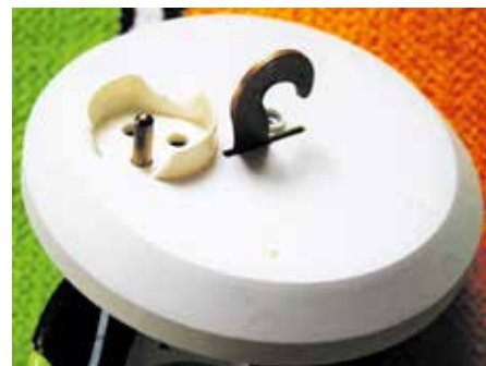
△ Haurastumisen takia rikkoontunut kattopistorasia kuuluu asioihin, joista pitää tehdä vikailmoitus. Vaihdon saa tehdä vain sähköasentaja. Suositus: sähköinen vikailmoitus, jossa on mukana kuva.
